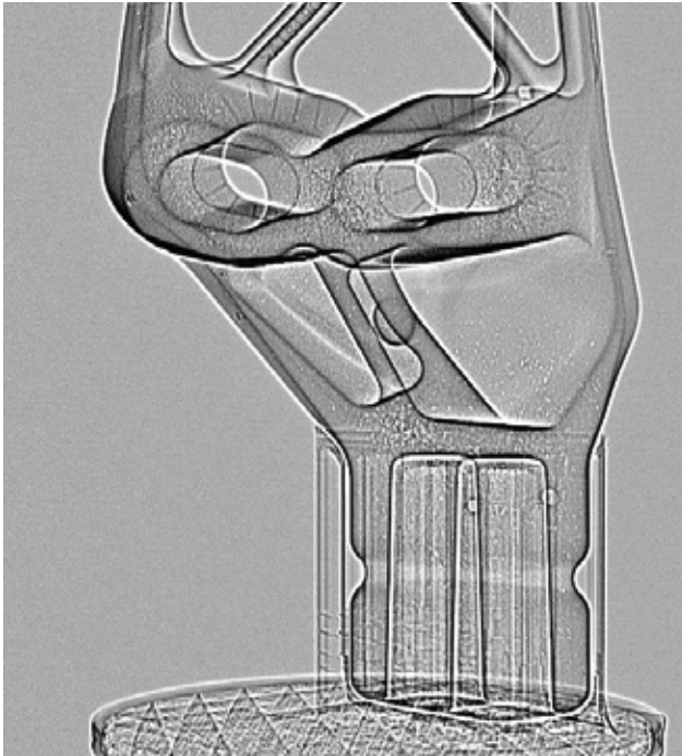
通过优化设定的手动二维镜像X射线图像。
