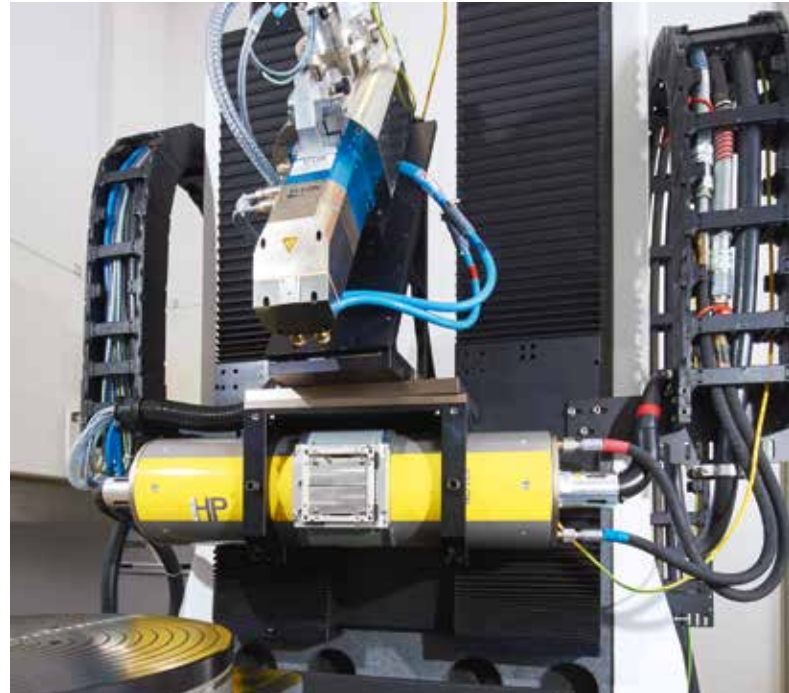
Hochenergetische Minifokusröntgenröhre und hochauflösende Mikrofokusröntgenröhre
