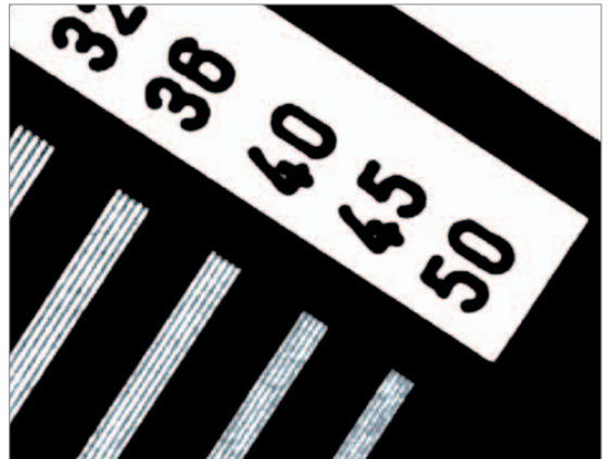
Pb-Linienraster bei Y.XRS235-D1000, M2
